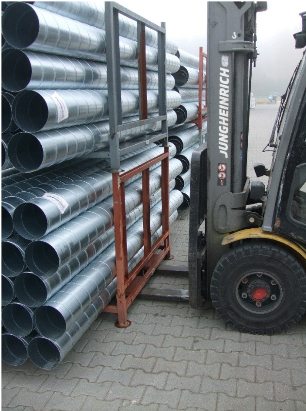
Fot 1. Podnoszenie boxu z przewodami prostymi PPS
