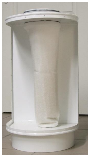
Fot 2. Widok filtra umieszczonego w nawiewniku wporowym.
