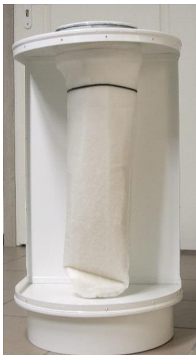
Fot 9. Nawiewnik z założonym filtrem i nieprawidłowo nasuniętą opaską mocującą.
