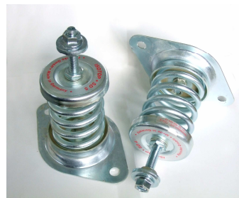
Zdjęcie nr 13. Wibroizolatory sprężynowe.
