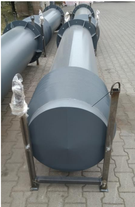
Konstrukcja transportowa z uchwytami górnymi - widok od strony dachu czerpni.
