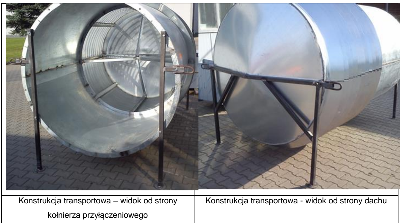
Rys. 2. Schemat konstrukcji transportowej \varnothing 800 - \varnothing 1400 mm.
